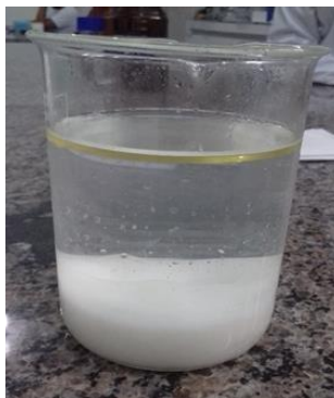
Imagem 1: Saponificação indesejada durante a síntese de biodiesel com catalisador KOH.
